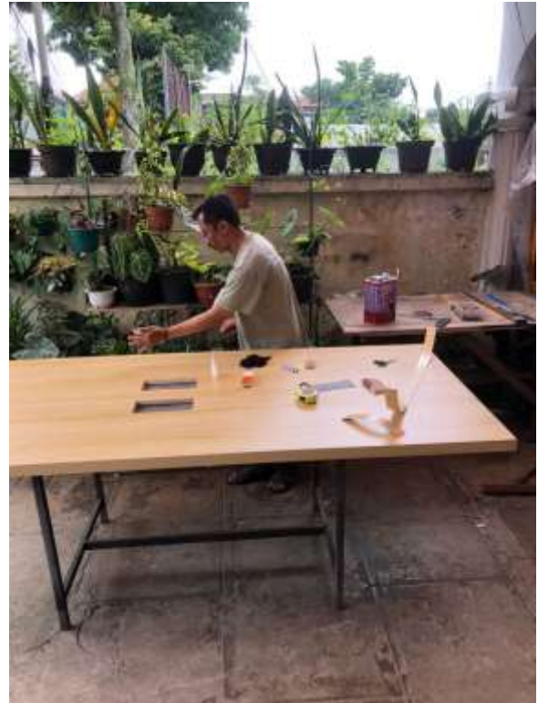
Gambar 8. Proses pelapisan HPL
