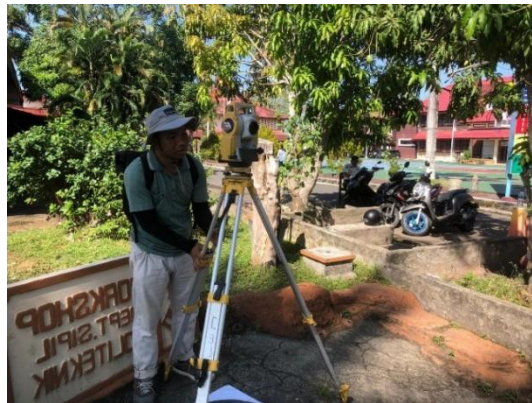
Gambar 3. 4 Penggunaan Total Station untuk akuisisi data Topografi
