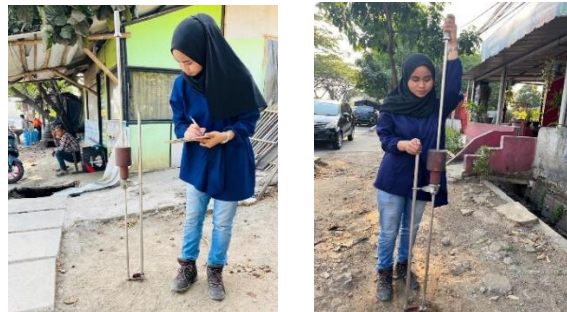
Gambar 4.2 Pengujian DCP (Dynamic Cone Penetrometer) Tanah pada 9 titik pengujian di ambil 300 m per titik pada panjang jalan 2.700 m
