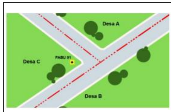
Gambar 2.7 Pemasangan Pilar Acuan Batas Utama (PABU) (Permendagri, 2016)
