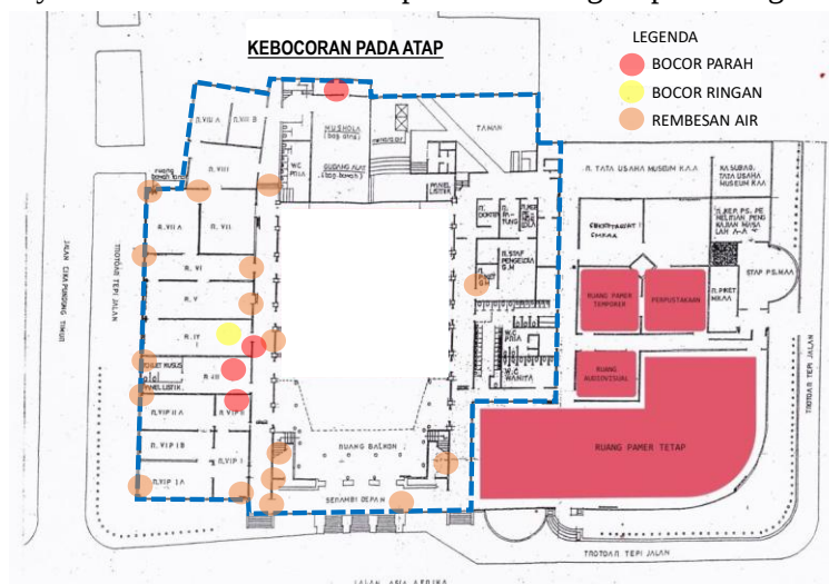
Gambar 2.3 Zoning Kebocoran Gedung Kantor
